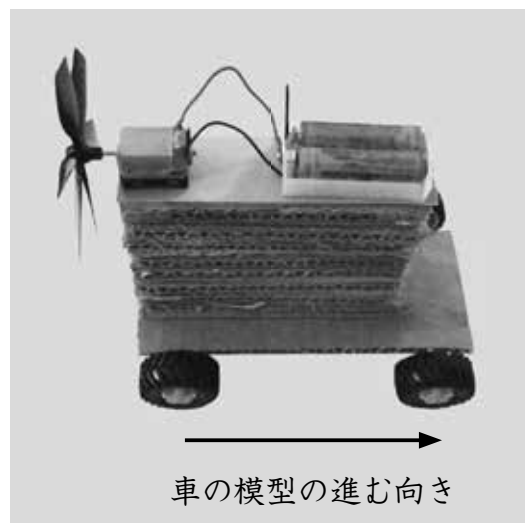
図1 風を起こして走る車の模型 もけい
